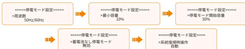
蓄電池なし停電モードでは、自立端子の出力は蓄電池付きパワーコンディショナ出力の半分(50%)に制限されます。
