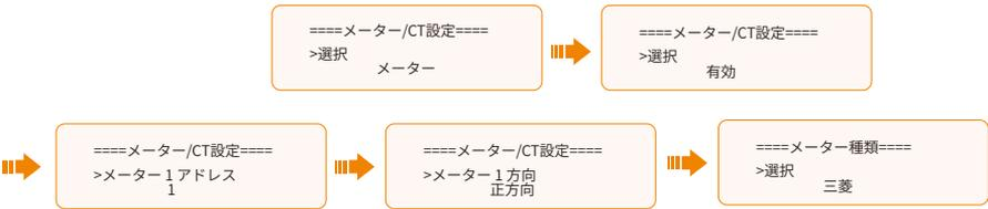
(2) メーター2のアドレスと向きを設定します。「外部パワコン」で「有効」を選択します。
